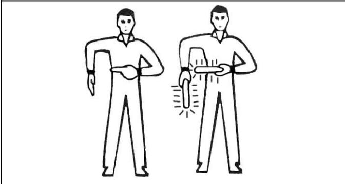
Fig. 45 **HOT BRAKES LEFT SIDE**
